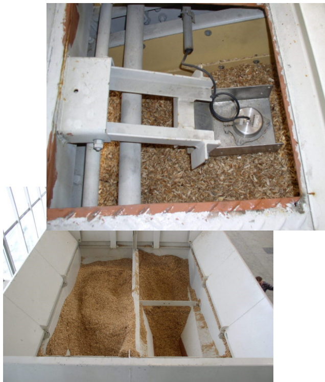
Litronic-FMS II bestehend aus intelligentem Sensor, Auswertelektronik und Software.
