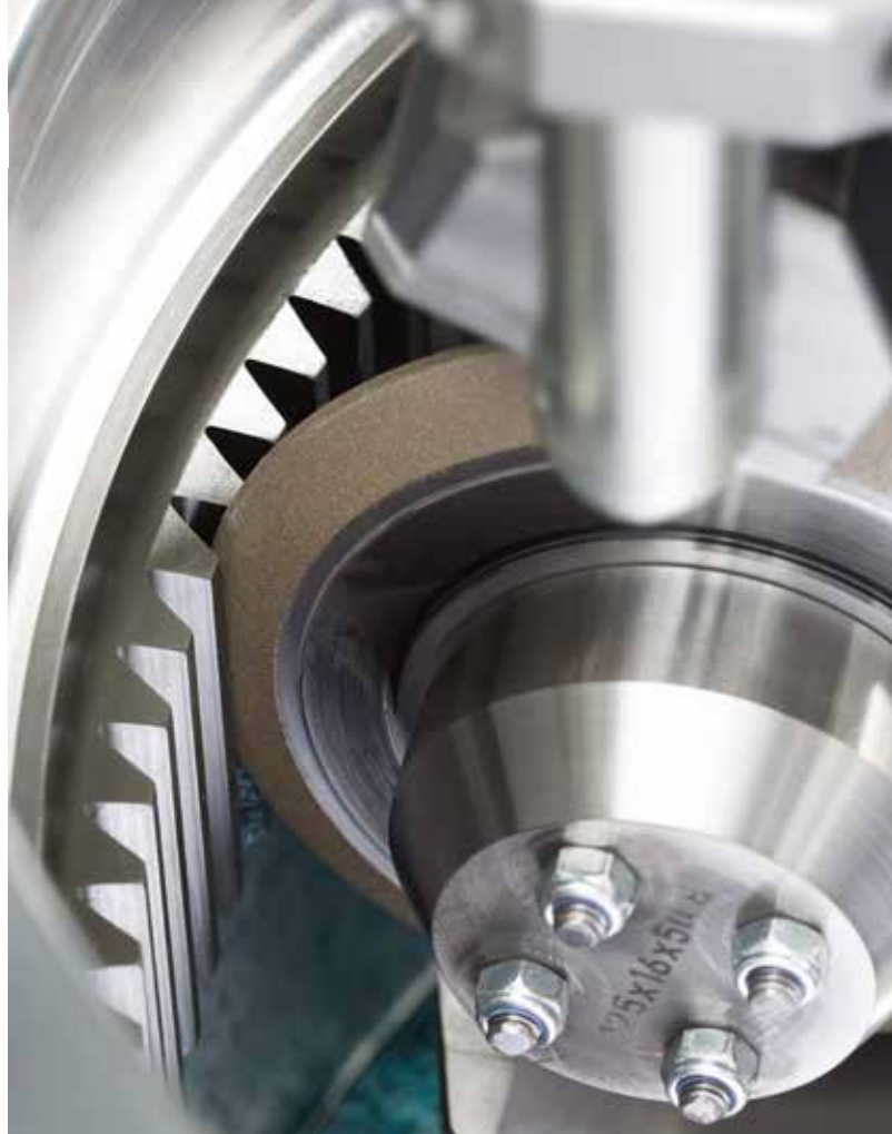
Der neue Schleifkopf mit CBN-Schleifscheibe
