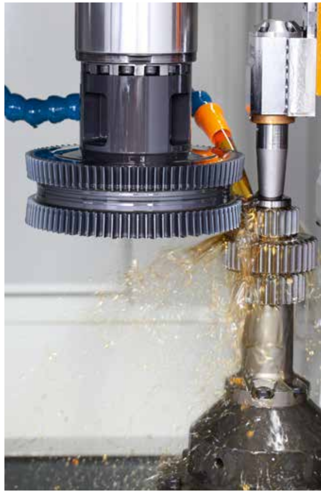
Die LS 180 F ist ideal für die Bearbeitung von Mehrfachverzahnungen
