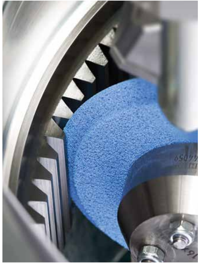
Abrichtbare Cubitron™ II Profilschleifscheibe
