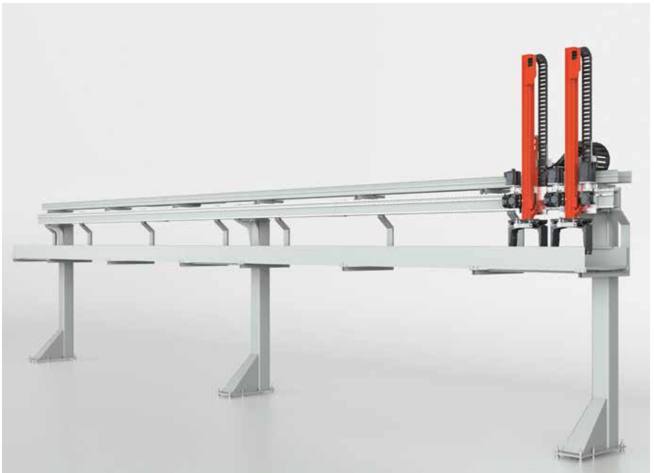
Das Ladeportal LP 100 kann auch mit größeren Abständen zwischen den Stützen gebaut werden
