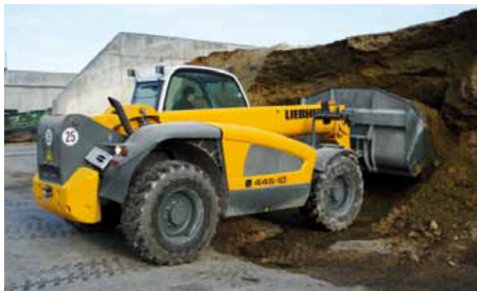
Hydrostatický pohon pojezdu: enormní síla pronikání při nakládce.
