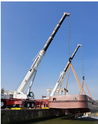
liebherr-ltm-1150-5-3-mantovani-2.jpg Zwei 5-Achser bei der Arbeit: Das Anheben der Plattform ist ein Kinderspiel.
