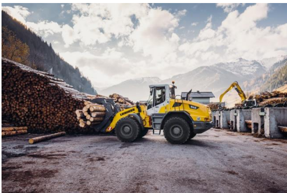
liebherr-new-mid-sized-wheel-loader-l546-timber.jpg Neues Hubgerüst mit hoher Leistungskraft: Der neue Liebherr-Radlader L 546 transportiert Holzstämmе mit einem Holzgreifer.
