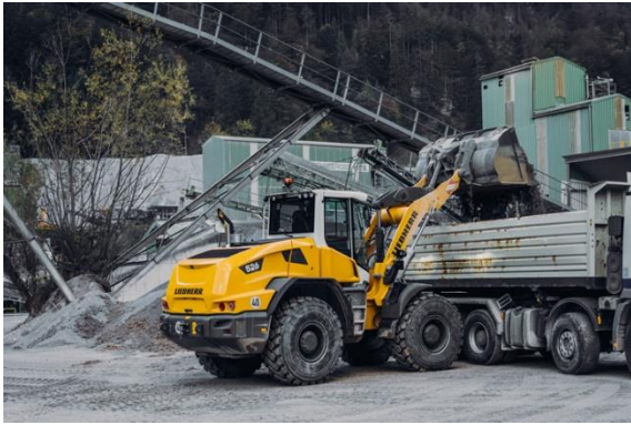
liebherr-new-mid-sized-wheel-loader-l526-quarry.jpg Mehr Motorleistung, höhere Ausbrechkräfte: Der neue Liebherr-Radlader L 526 beim Beladen eines Lkw.
