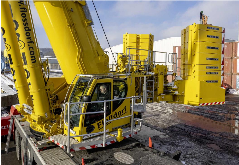
liebherr-ltm1650-8-1-flosdorf-3.jpg 155 Tonnen wiegen die Ballastblöcke. VarioBallast® ist hier auf Maximaldistanz gestellt.
