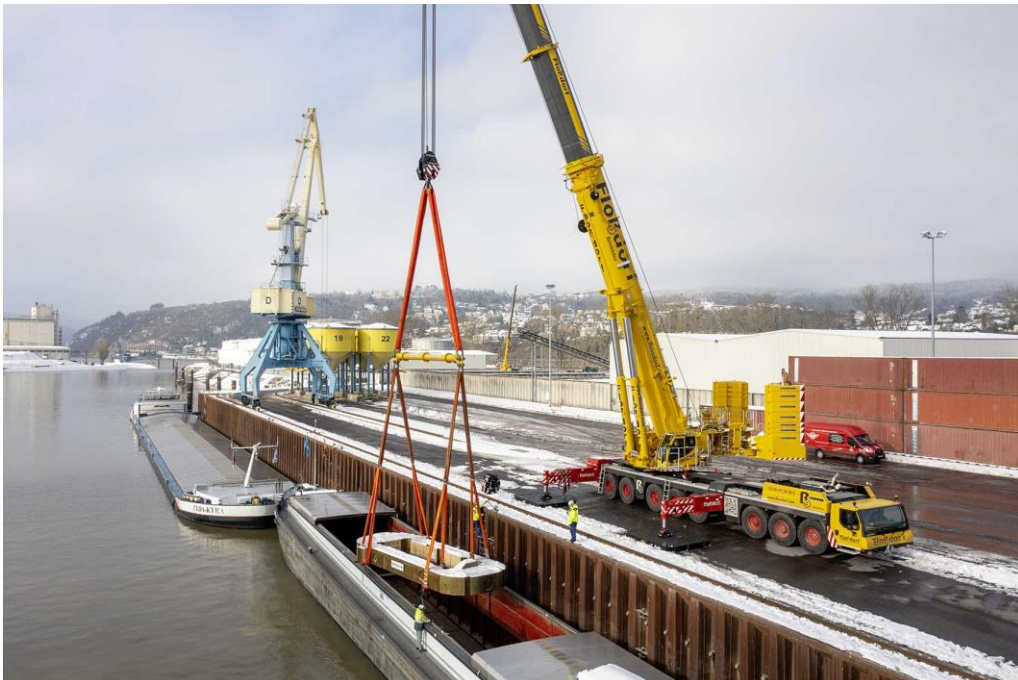
liebherr-ltm1650-8-1-flosdorf-4.jpg Bei über 15 Meter Ausladung versenkt der Liebherr-Kran die 115 Tonnen schwere Bruttolast im Schiffsbauch.
