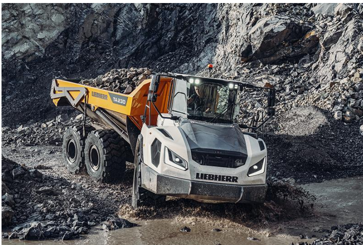
Liebherr-ta230-litronic.jpg Der TA 230 Litronic ist für anspruchsvolle Offroad-Einsätze wie die Gewinnungsindustrie konzipiert. Moderne Assistenzsysteme erhöhen die Produktivität und Sicherheit im Betrieb.
