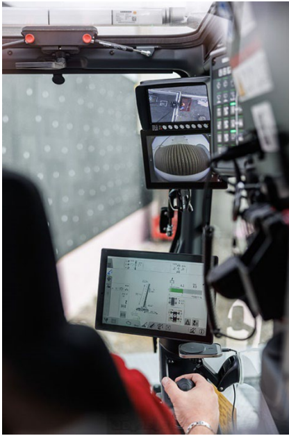
liebherr-ltm1110-5.2-bkl-03.jpg Alles im Blick: LICCON3-Display mit Touch-Funktion. Diverse Kameras sind optional erhältlich.
