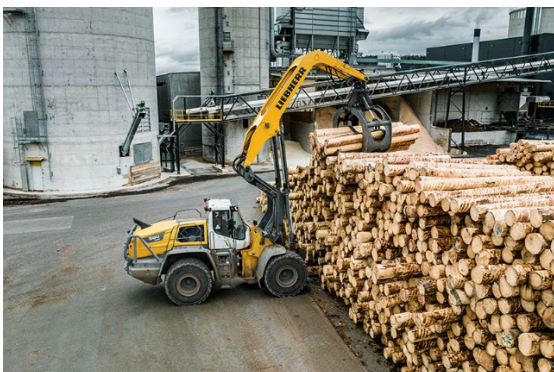
liebherr-l580-loghandler-xpower-rubner-timber-handling-austria.jpg Les bras de levage spéciaux de la L580 LogHandler XPower® permettent de grandes hauteurs de manipulation et de longues portées.
