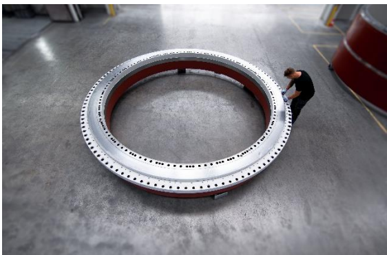
Liebherr-Verankerungslager-vormontiert-für-schwimmende-Windkraftanlage.jpg Verankerungslager mit einem Durchmesser von vier Metern sorgen für die Selbstausrichtung von schwimmenden Windkraftanlagen.
