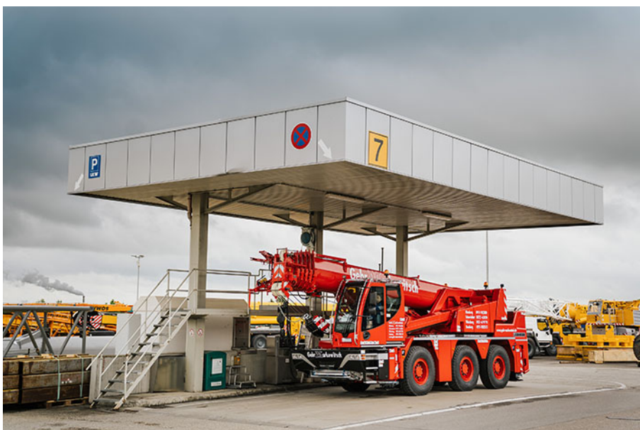
liebherr-hvo-test-kynningsrud.jpg Liebherr erprobt den Einsatz von HVO-Kraftstoff in einem Mobilkran LTM 1090-4.2 in Norwegen.
