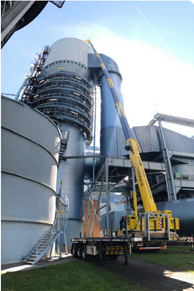
liebherr-ltm1110-5-1-klema-power-plant.jpg Ersteinsatz mit Maximalballast und Doppelklappspitze im Kraftwerk Zolling.
