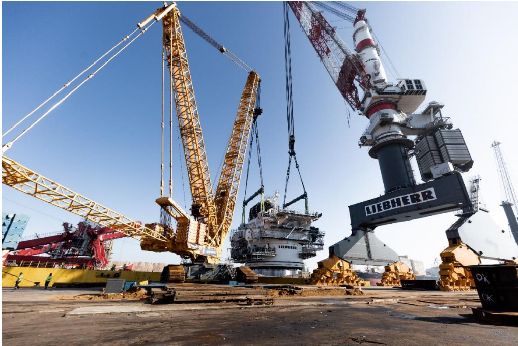
Tandemhub direkt am Kai: Zwei leistungsstarke Liebherr-Krane, der Raupenkran LR 11350 und der TCC 78000, heben die Drehbühne des HLC 150000 auf die BigLift Barentsz.
