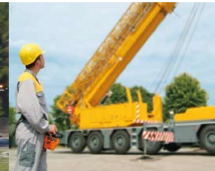
Einfache Ein-Mann-Montage mittels Funkfernsteuerung.
