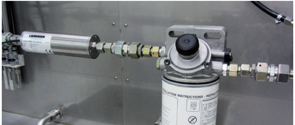
Exemple de sonde Litronic®-FMS III / RMH 12 intégrée sur banc d'essai en laboratoire (mesure de la capacité de d'émulsification d'un filtre à gasoil)
