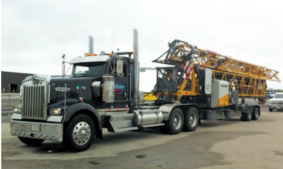
Dank einem idealen Packmaß von 2,60 m x 4,00 m kann der 81K einfach per Schiff, LKW oder Bahn transportiert werden. Der Kran ist ca. 16,5 m lang.
