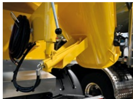
Goulotte de vidange avec relevage hydraulique : mécanique/hydraulique ou entièrement hydraulique
