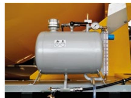
Réservoir adjuvant pressurisé
