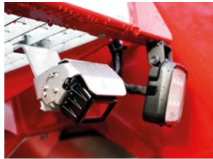
Caméra de recul et un phare à LED à l'arrière de série (DIN-EN 12609)
