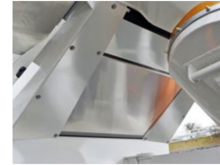
Protection du châneau arrière avec joint en caoutchouc sur le V de déchargement
