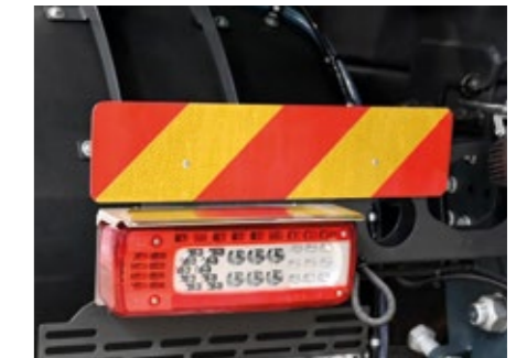
Autocollants rétro-réfléchissants au-dessus des blocs feux arrière
