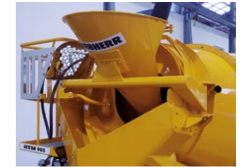
Trémie de remplissage pivotant mécaniquement sur le côté
