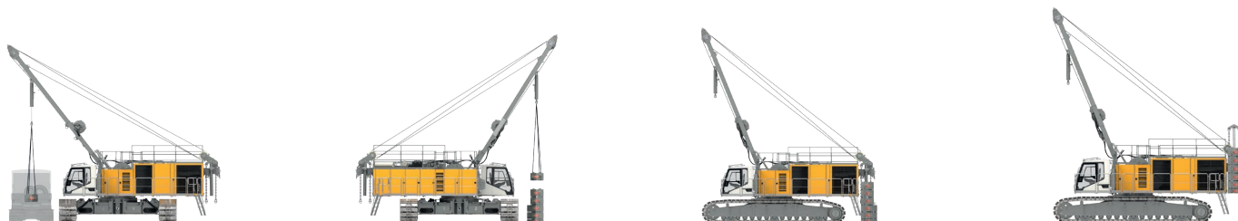
Descarregamento e montagem do contrapeso traseiro
