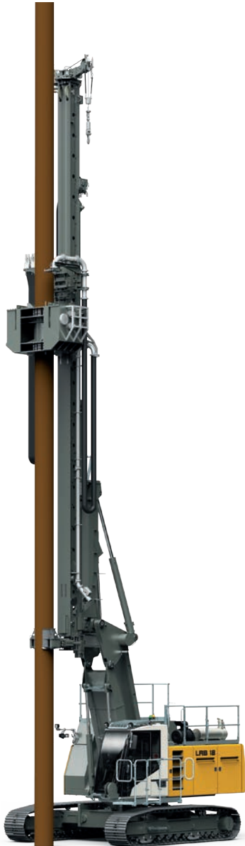
Longitud máx. de tubo 27 m
