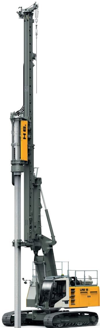
Longitud máx. de pilote 16.4 m
