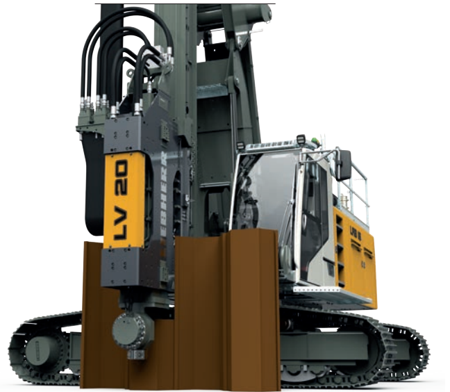
Vibración de una tablestaca simple entre otras dos tablestacas
