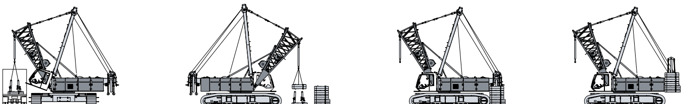
Descarga y montaje del contrapeso
