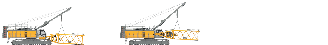
Montagem do pé da lança
