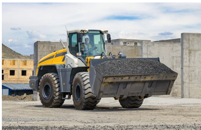
新疆恒石建筑材料有限公司十分欣赏采用静液压传动技术的利勃海尔轮式装载机。
