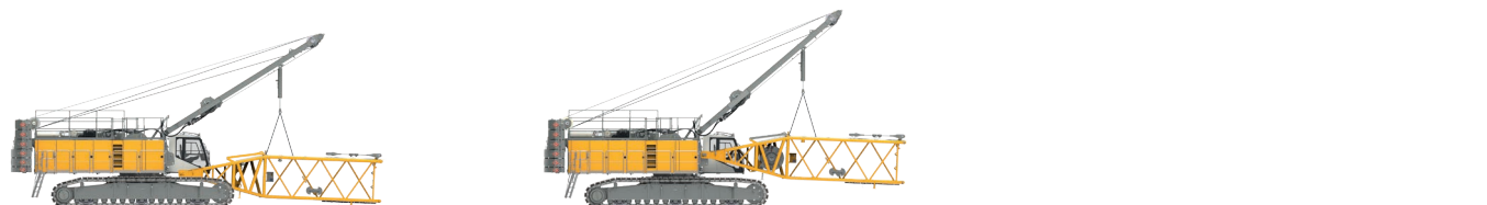
Montagem do pé da lança
