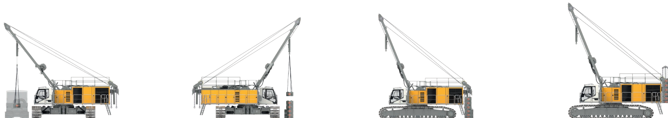
Descarregamento e montagem do contrapeso traseiro
