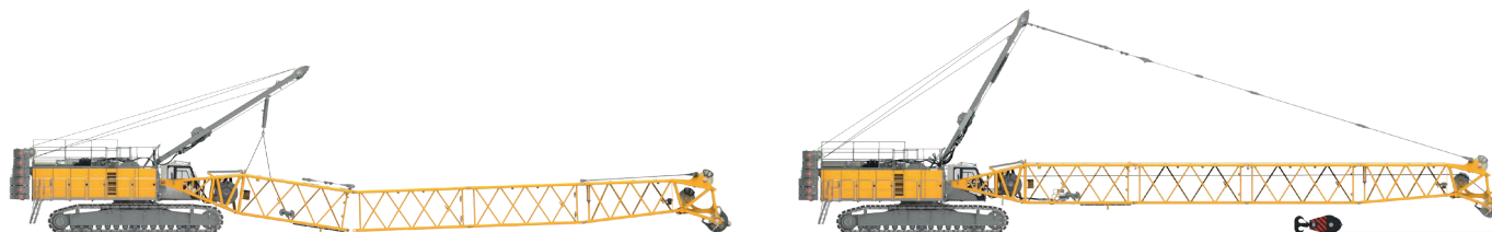
Montagem da lança
