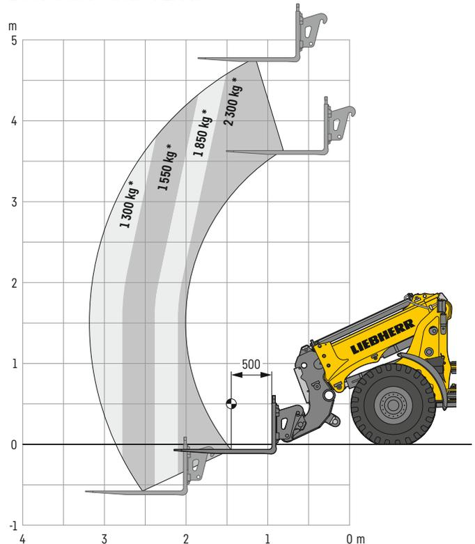
\* Coefficient de sécurité pour la détermination de la charge nominale sur terrain plat et dur = 80% de la charge de basculement articulé - selon EN 474-3
