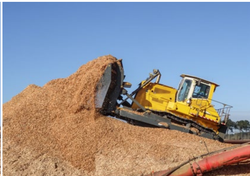
Travail en montée avec lame pleine.
