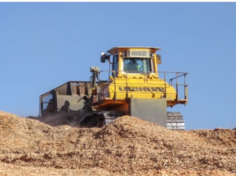
Le bouteur PR 764 est équipé à l'arrière d'un contrepoids.
