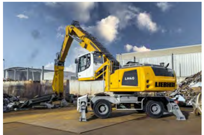
LH 40 M Industry Litronic no corte de vigas de aço com tesoura para sucata
