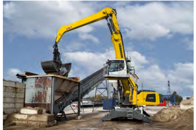
Carregamento de central de concreto com a LH 40 M Industry Litronic
