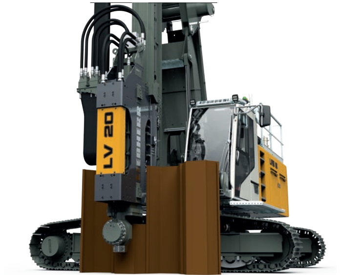
Vibración de la tablestaca simple entre otras dos tablestacas
