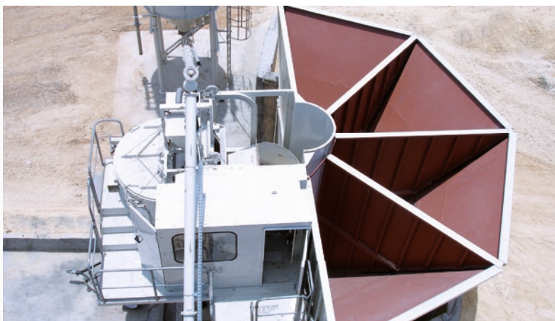
Карманный бункер. Количество камер: 4. Объем склада: 40 м 3 .
