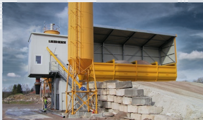
Сompactmix 1.0 для использования в качестве завода по производству товарного бетона.
