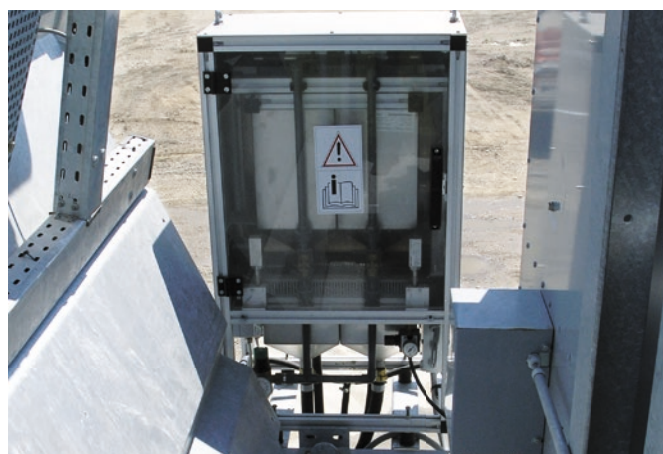
Весы для химических добавок из нержавеющей стали.
