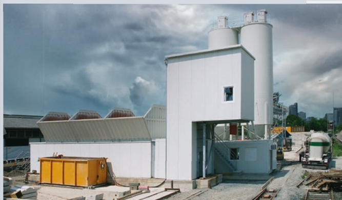
Сompactmix 1.0 на строительной площадке метро.
