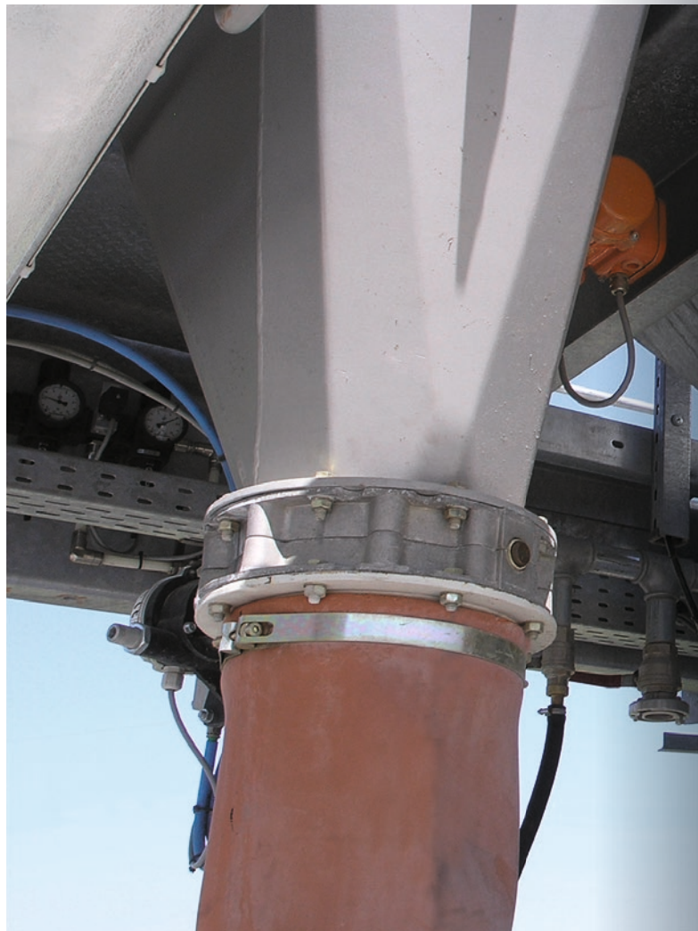
Высококачественные системы взвешивания над платформой смесителя.
