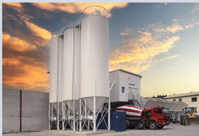
Сompactmix 1.0 с обшивкой для зимней эксплуатации.
