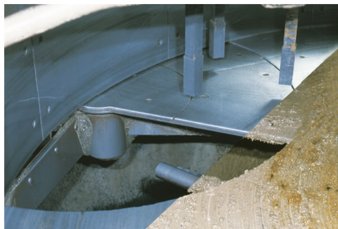
Автоматическая очистка смесителя под высоким давлением.
