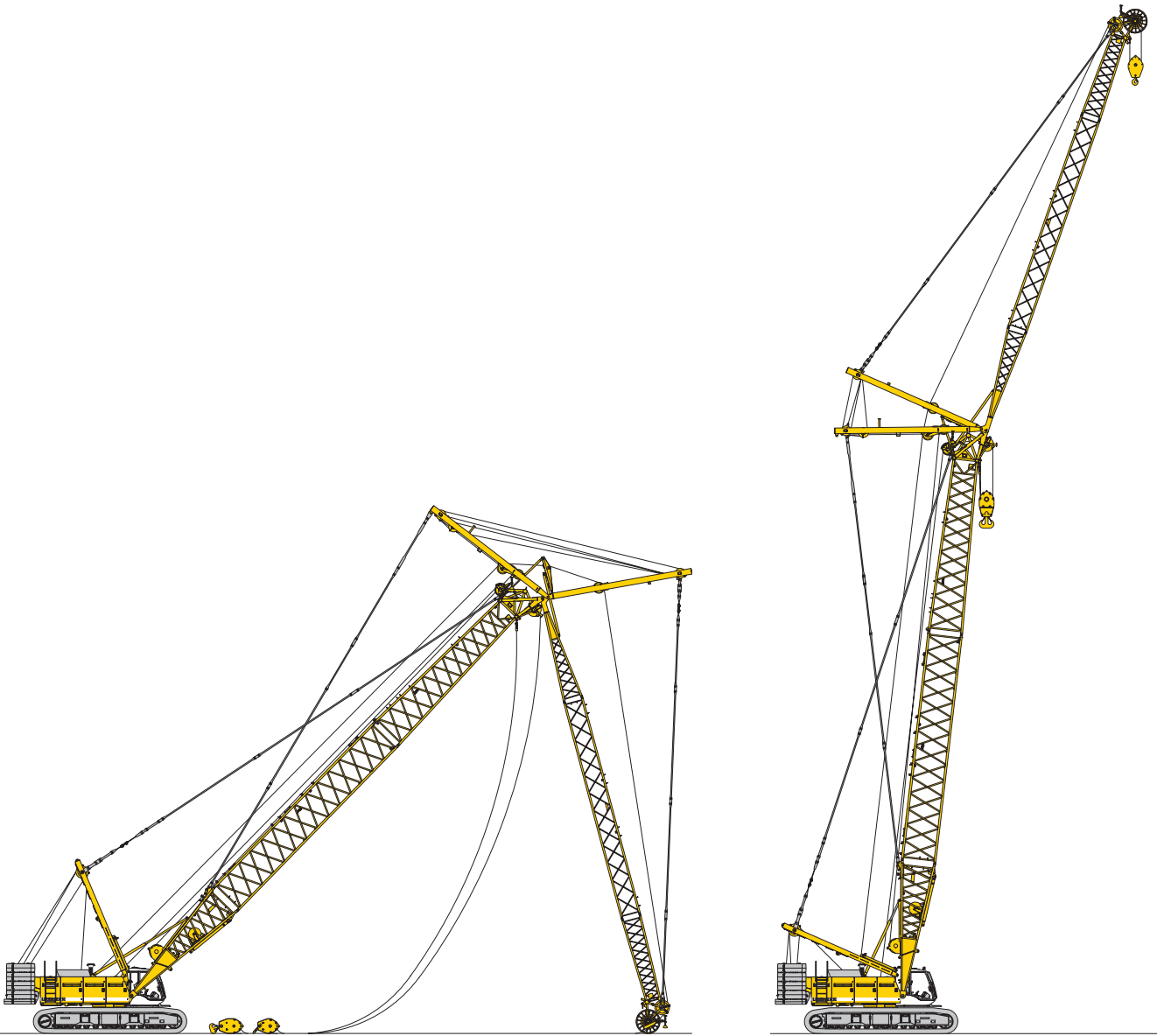
Elevación de la pluma principal y del plumín abatible
