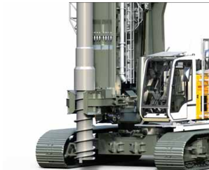
Outil pour pieux refoulés avec guide-tarière
