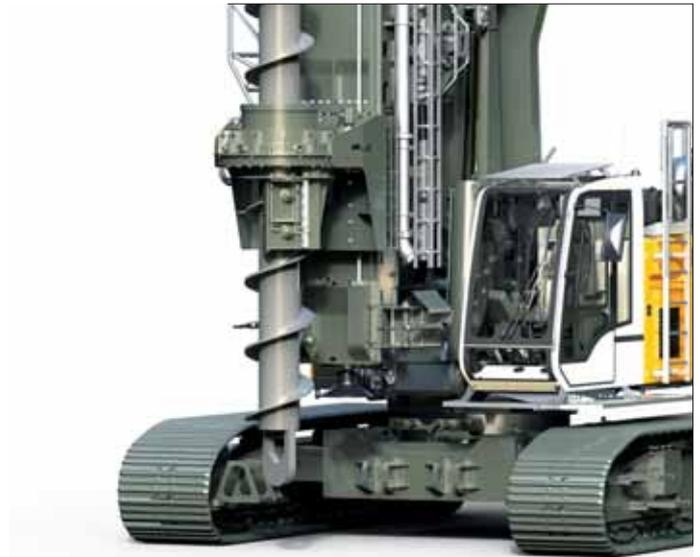
Bohrschnecke mit Schneckenputzer
