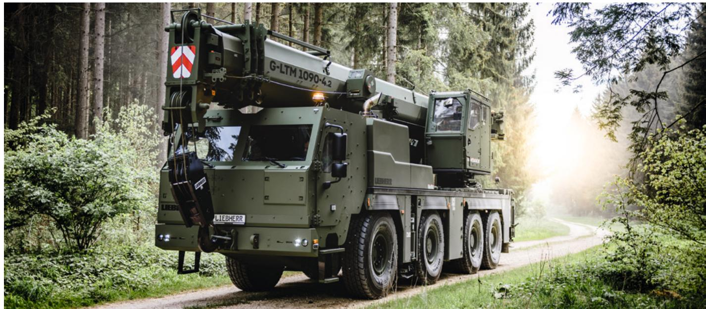
**Das All-Terrain-Fahrgestell des G-LTM 1090-4.2 mit modernster Fahrwerks- und Antriebstechnik bietet hervorragende Fahreigenschaften im Gelände.**
