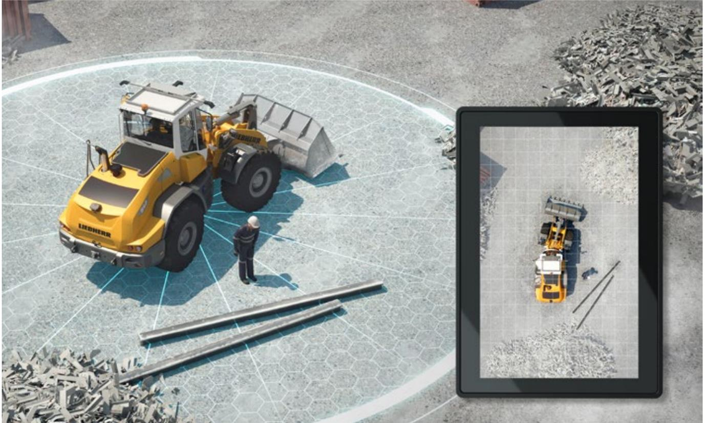
Alles im Blick – das Assistenzsystem „Skyview 360°“ ist grundlegend überarbeitet worden und besticht mit hochauflösender Bildqualität. Das System bietet eine komplette Übersicht über das ganze Maschinenumfeld, wodurch Gefahrenquellen frühzeitig erkannt und Unfälle verhindert werden. Die Arbeitszyklen können schneller, effektiver und sicherer durchgeführt werden, dies spart Zeit und Kosten.
