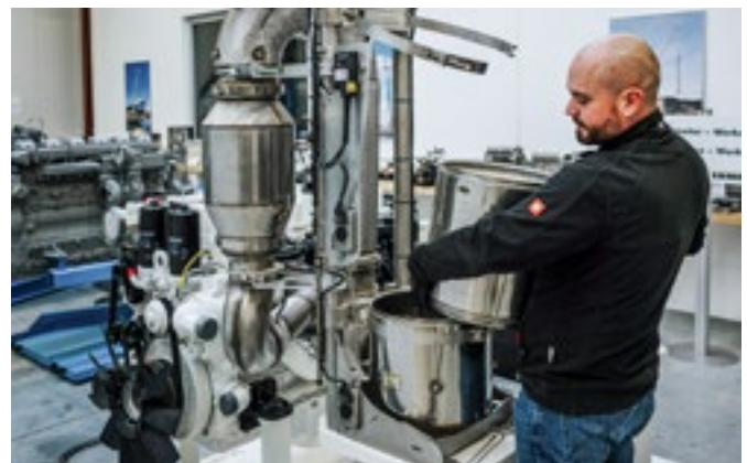
Trainer Thomas Fritsch demonstriert den Wechsel eines Dieselpartikelfilters an einem Modell im Liebherr-Schulungszentrum in Ehingen.
