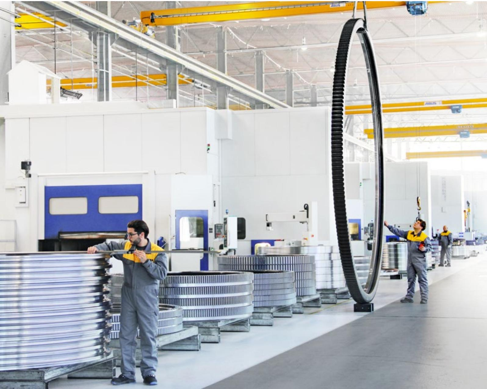
Liebherr baut Großwälzlager für ein breites Anwendungsspektrum in allen Gewichts- und Durchmesserklassen. Wir liefern alle gängigen sowie speziellen Verzahnungsmodule – optional außen-, innen- oder unverzahnt.
