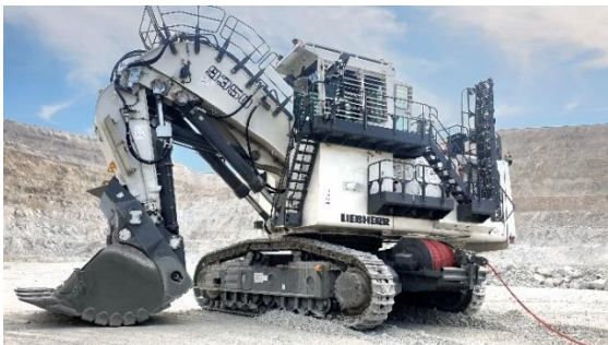
liebherr-cable-reel.jpg El carrete de cable de Liebherr puede utilizarse para las excavadoras eléctricas R 9150 a R 9800.
