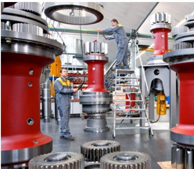
Montage von Drehantrieben des Typs DAT 1000
