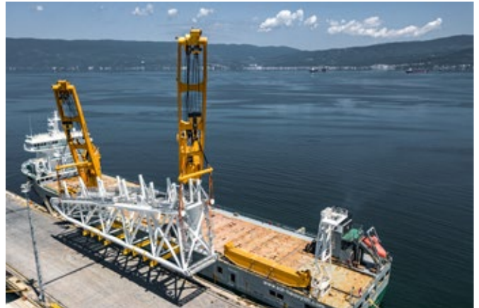
Der Liebherr CBB 4700-450 als Teil des vielseitigen Schiffskranportfolios beim Umschlag eines Auslegers
