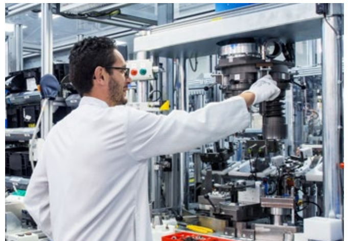
Montage von Common-Rail-Systemen im Reinraum
