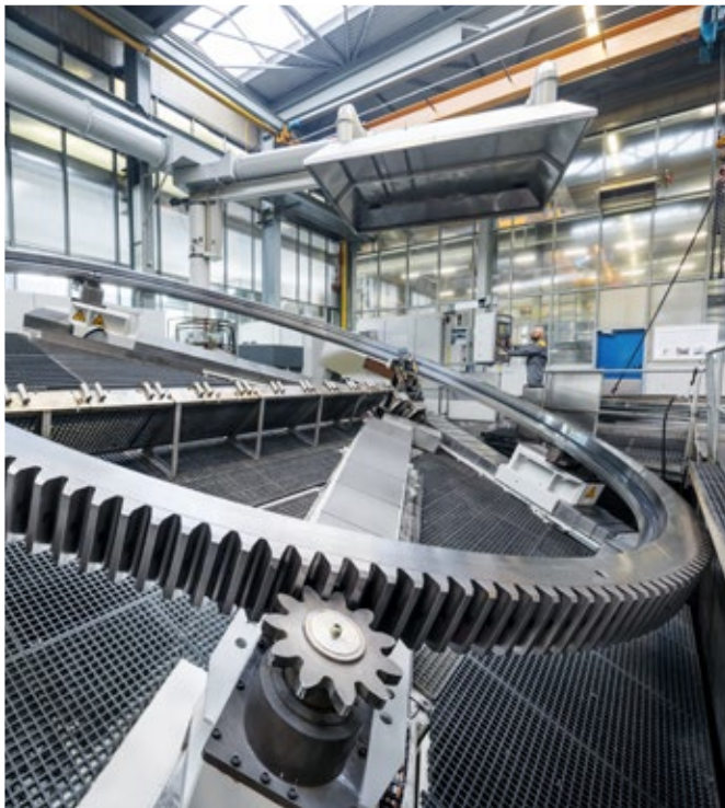
Induktive Härtung von Großwälzlagern
