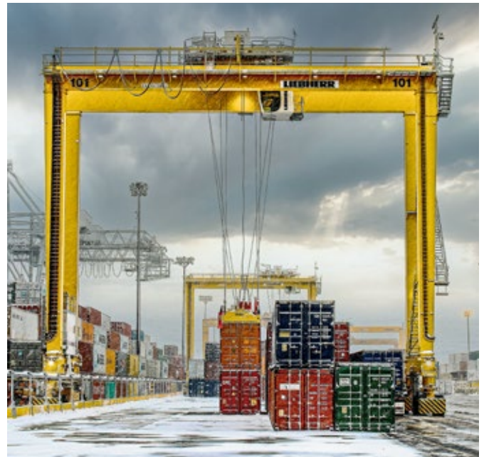
Ein gummiereifter Liebherr-Containerstapelkran mit Elektroantrieb an den Montreal Gateway Terminals (Kanada)
