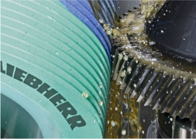
Feinbearbeitung durch Schleifen und Polieren
