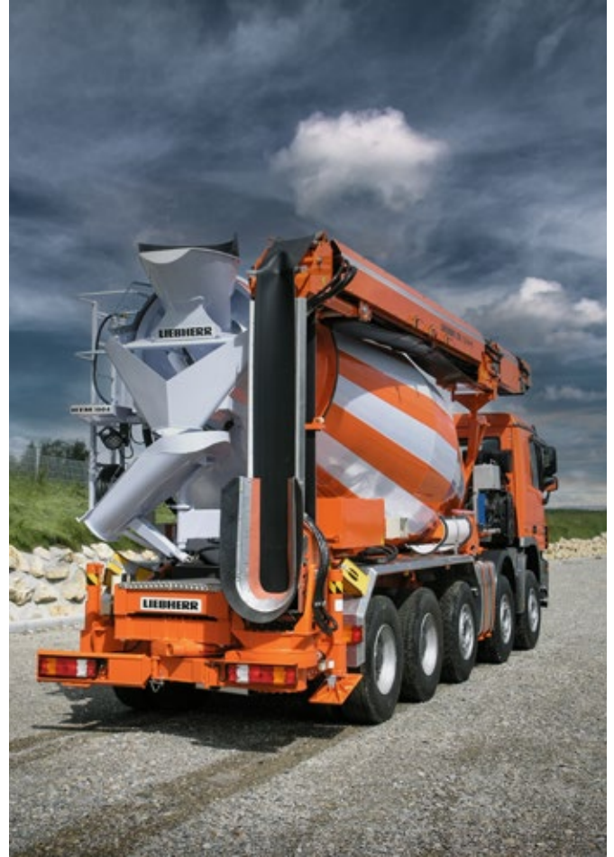
Der Fahrmischer HTM 1004 mit Doppelteleskop-Förderband LTB 12+4+1
