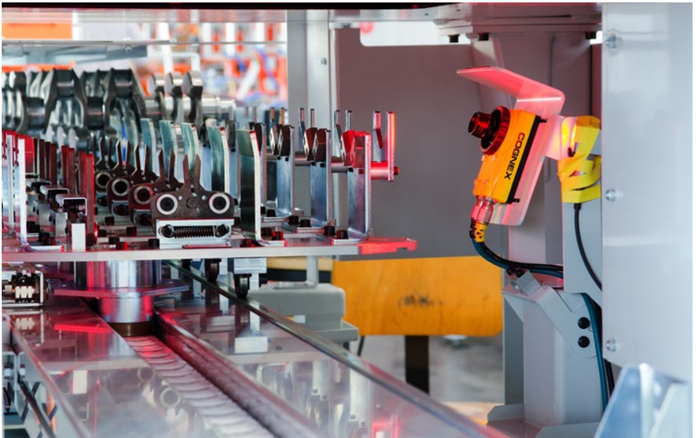
Das Kunststoffkettenband (KKB) als Fördersystem beispielsweise für Kurbelwellen
