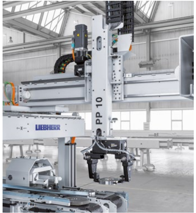
Portalroboter für Werkstücke mit einem Gewicht von 0,5 kg bis 1.500 kg
