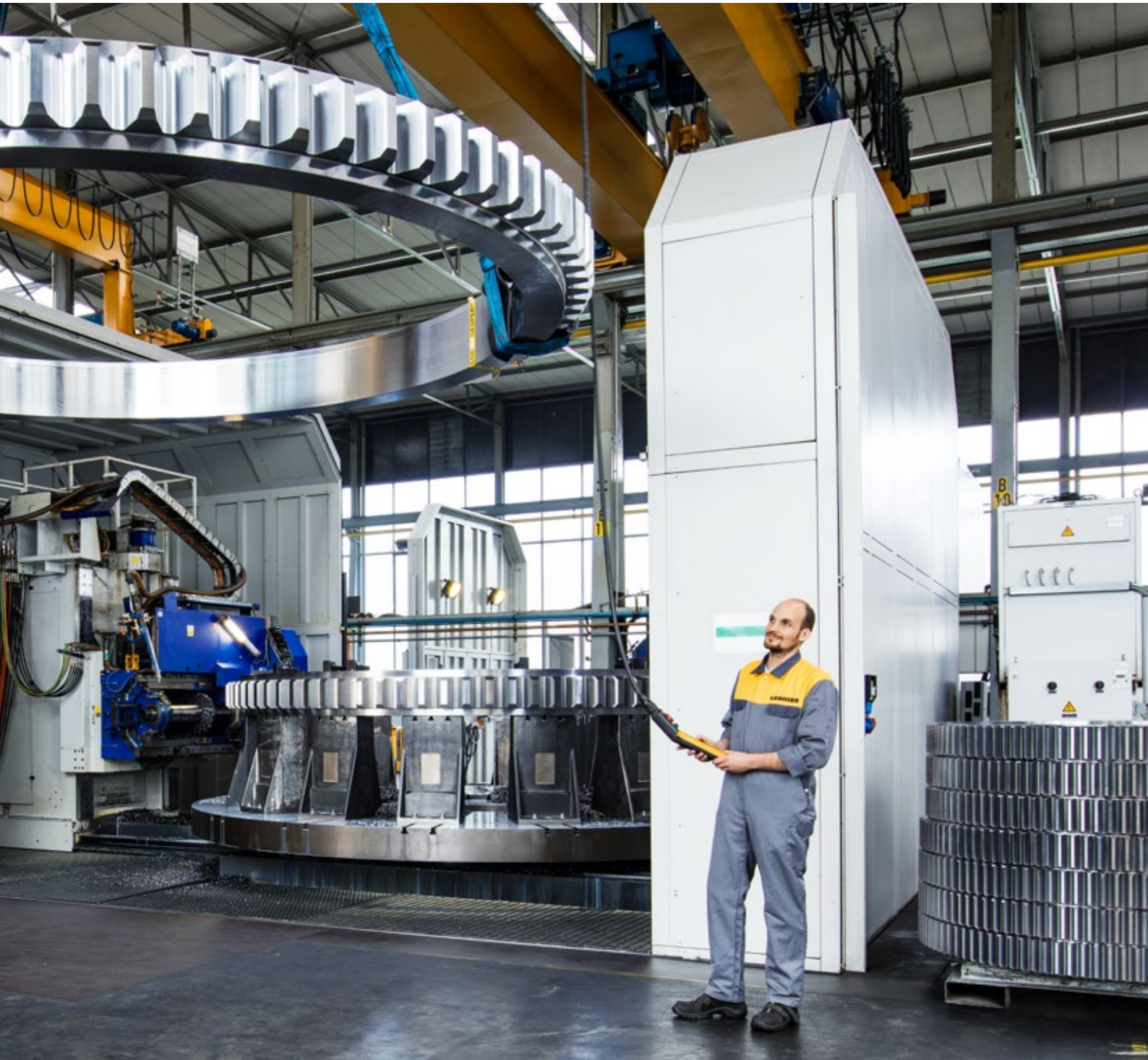
Feinbearbeitung durch Schleifen und Polieren
