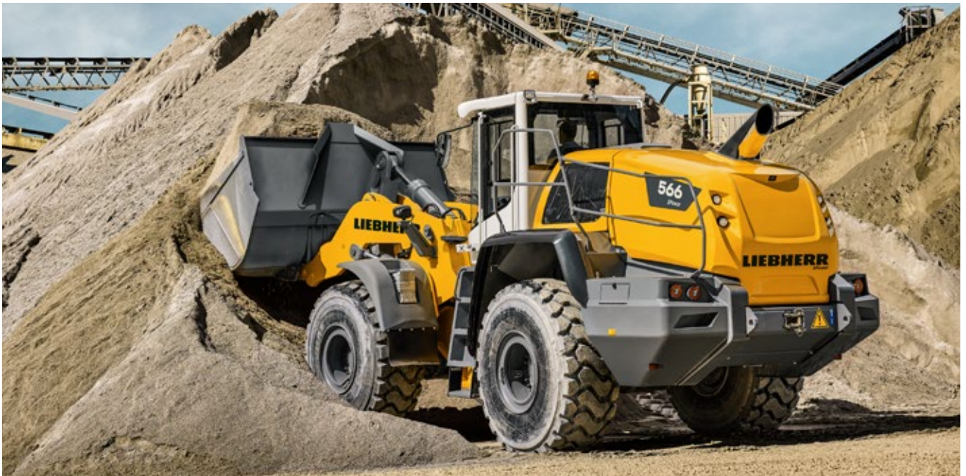
Der L 566 XPower® im Schottereinsatz
