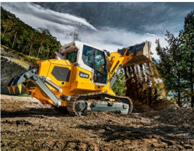
Die Laderraupe LR 626 G8.0 in der Geländerschließung
