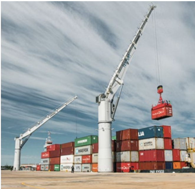
Ein Fixed Cargo Crane FCC 280 beim Umschlag von Containern in San Antonio (Paraguay)
