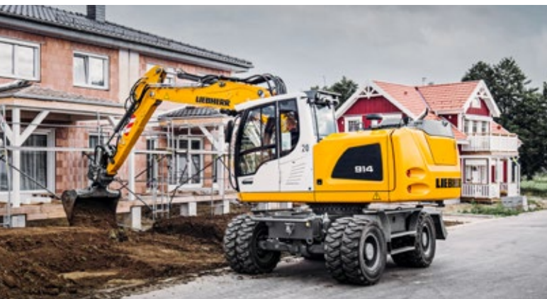
Der A 914 Litronic mit Schnellwechselsystem LIKUFIX® und Schwenklöffel beim Einsatz im Garten- und Landschaftsbau
