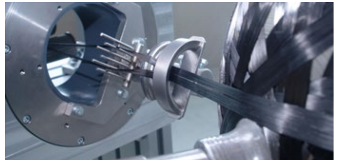
Fertigung mit der eigenen CFK-Wickelmaschine
