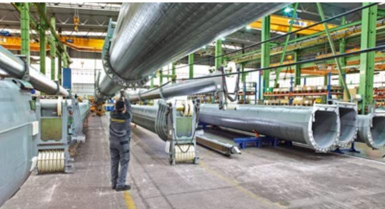
Montage von Teleskopauslegern
