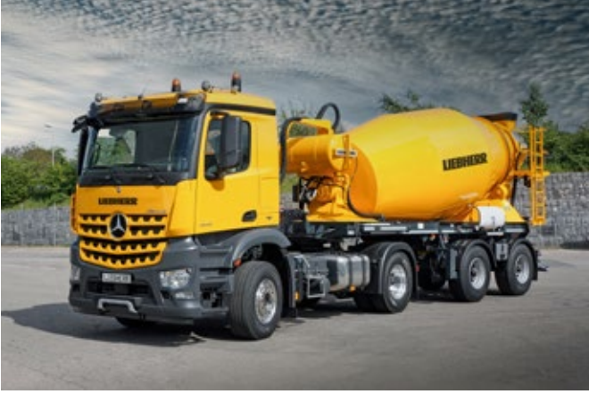
Der Fahrmischer HTM 1004 ZA/38 ist für 38 t Gesamtgewicht zugelassen
