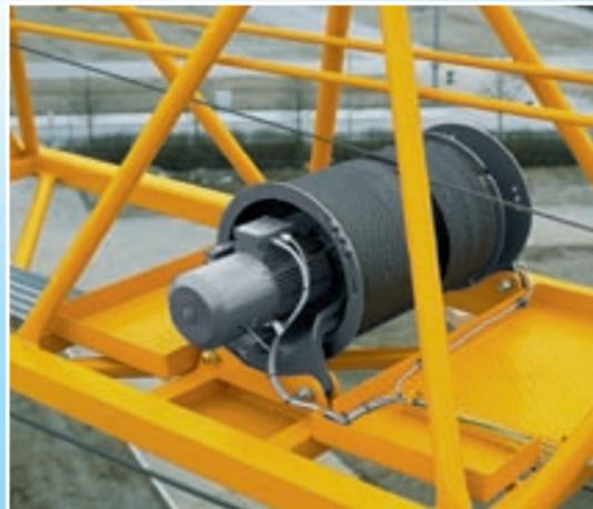
Frequenzgesteuertes FU-Katzfahrwerk: Stufenloses Fahren bei hohen Katzfahrgeschwindigkeiten.
