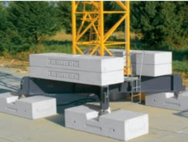
Das stationäre Fundament-Kreuz mit Fundamentblöcken.
