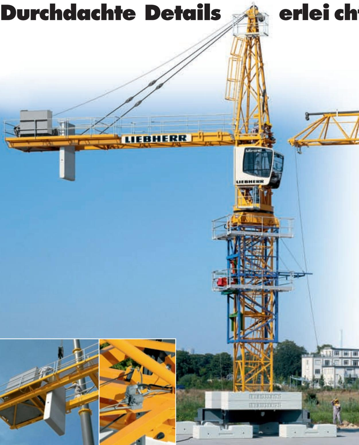
Der komplette Ausleger wird am Boden vorinstalliert. Die Laufkatze und der Lasthaken bilden eine Montageeinheit. Das Einscheren und Spannen des Katzfahrseils erfolgt schnell und einfach ohne Stromanschluß, da die Trommel mit offener Bremse frei gedreht werden kann.
