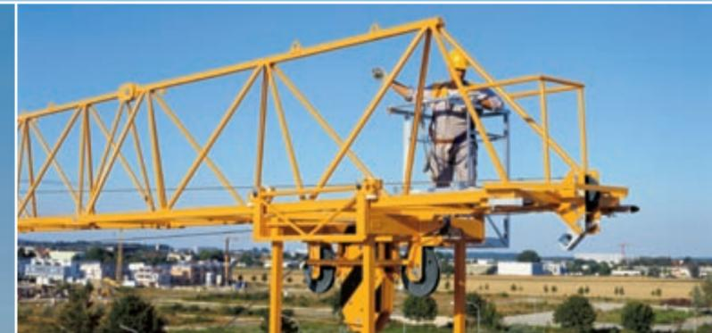
Einfaches Verbolzen des Hubseils an der Auslegerspitze.
