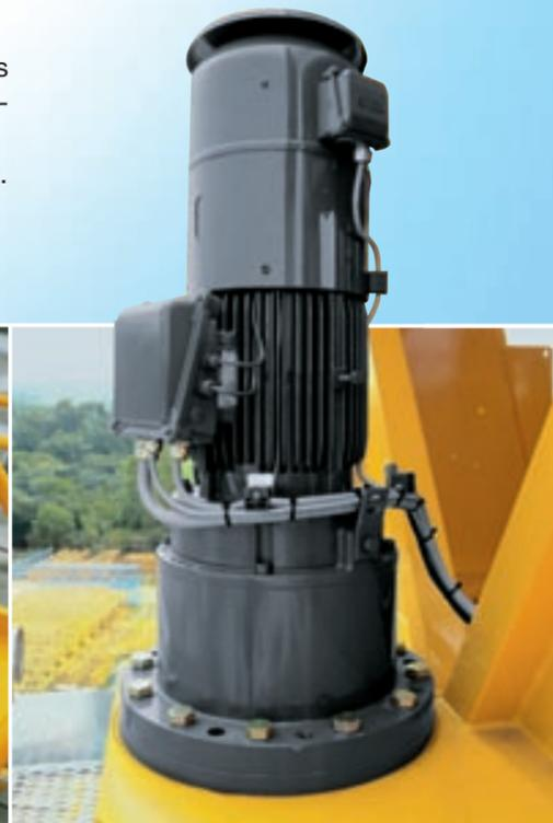
Patentiertes FU-Drehwerk: Feinfühlige und stoßfreie Drehbewegungen.
