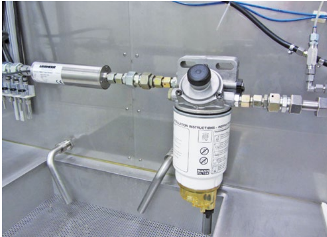
Litronic-FMS / RMH12 Sensor integriert in einem Teststand zur Überwachung des Wasserabscheidevermögens eines Dieseldieselfilters.
