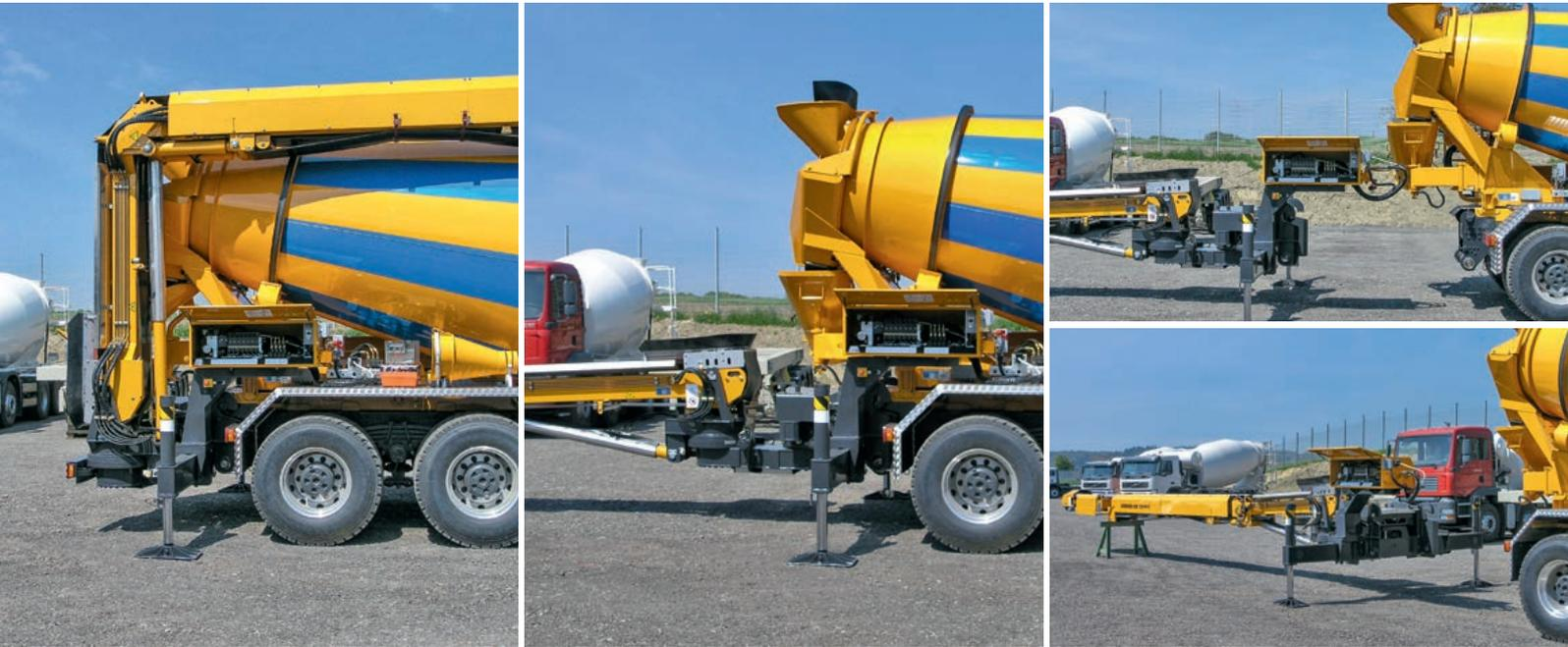
Das optionale Wechselsystem ermöglicht ein schnelles und einfaches An- und Abkoppeln des LTB-Förderbandes von Liebherr. Weitere Optionen stehen auf Anfrage zur Verfügung.
