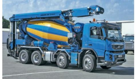
Fahrnischer und Förderband aus einer Hand, sowie der weltweite Liebherr-Service garantieren einen reibungslosen Betrieb. Das Liebherr-Förderband LTB kann an Fahrgestelle mit drei oder vier Achsen angebaut werden. Übliche Mischergrößen sind 7 m<sup>3</sup>, 8 m<sup>3</sup> und 9 m<sup>3</sup>.
