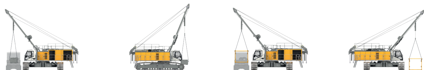
Entladung und Anbau des Zentralballastes
