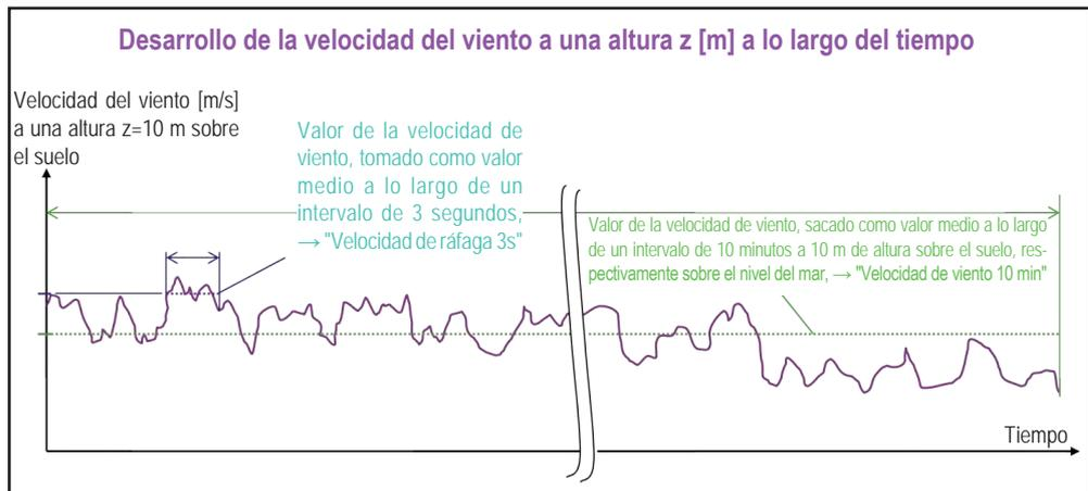
Imagen 9: Diagrama para la determinación de ráfagas de viento
