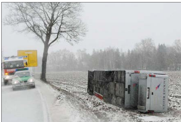
Figura 8: Ônibus virou após uma rajada de vento
