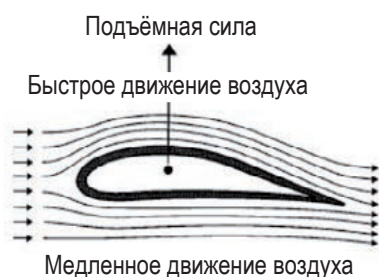
картинка 2: Принцип подъёмной силы
