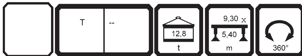
картинка 16: Выписка из таблицы грузоподъёмности с данными о допустимой скорости ветра для каждой конфигурации телескопической стрелы. / конфигурация решётчатой стрелы
